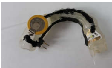
Figura 2.2. Circuitul hibrid cu senzor electronic și fibra optica incorporat în gutiera
