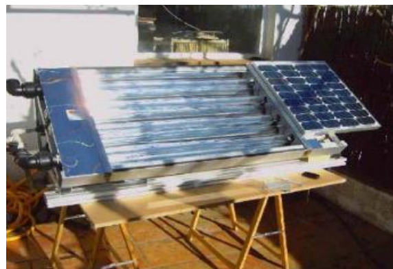
Fig. 65 Fotoreactor solar total autonom care potabilizează apa [105].
