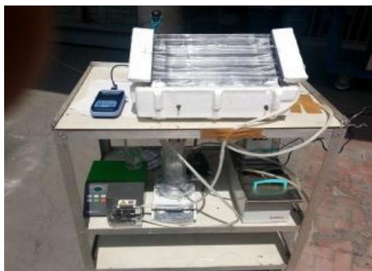
Fig. 66 Reactor multitubulat în Italia [106].
