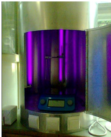
Fig. 2 Reactor fotocatalitic de laborator pentru optimizarea proceselor fotocatalitice.
