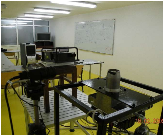
6 Stand pentru masurarea vitezei aerului utilizand tehnica PIV la curgerea dintr-un arzator turbionar
