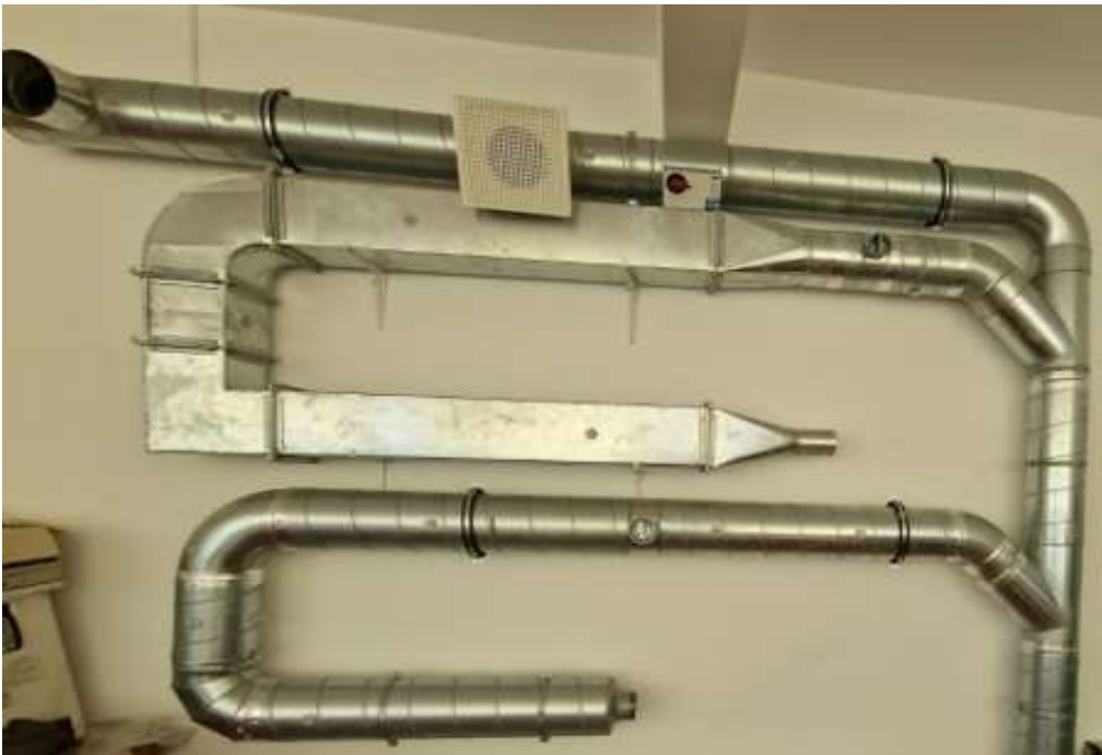
1 Stand pentru determinarea pierderilor de sarcina locale la curgerea prin tubulatura rectangulara si circulara
