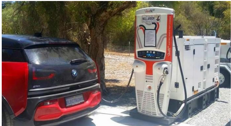
Figura 1.8. Stație de încărcare pentru vehicule electrice cu generator antrenat de un motor diesel [12].
