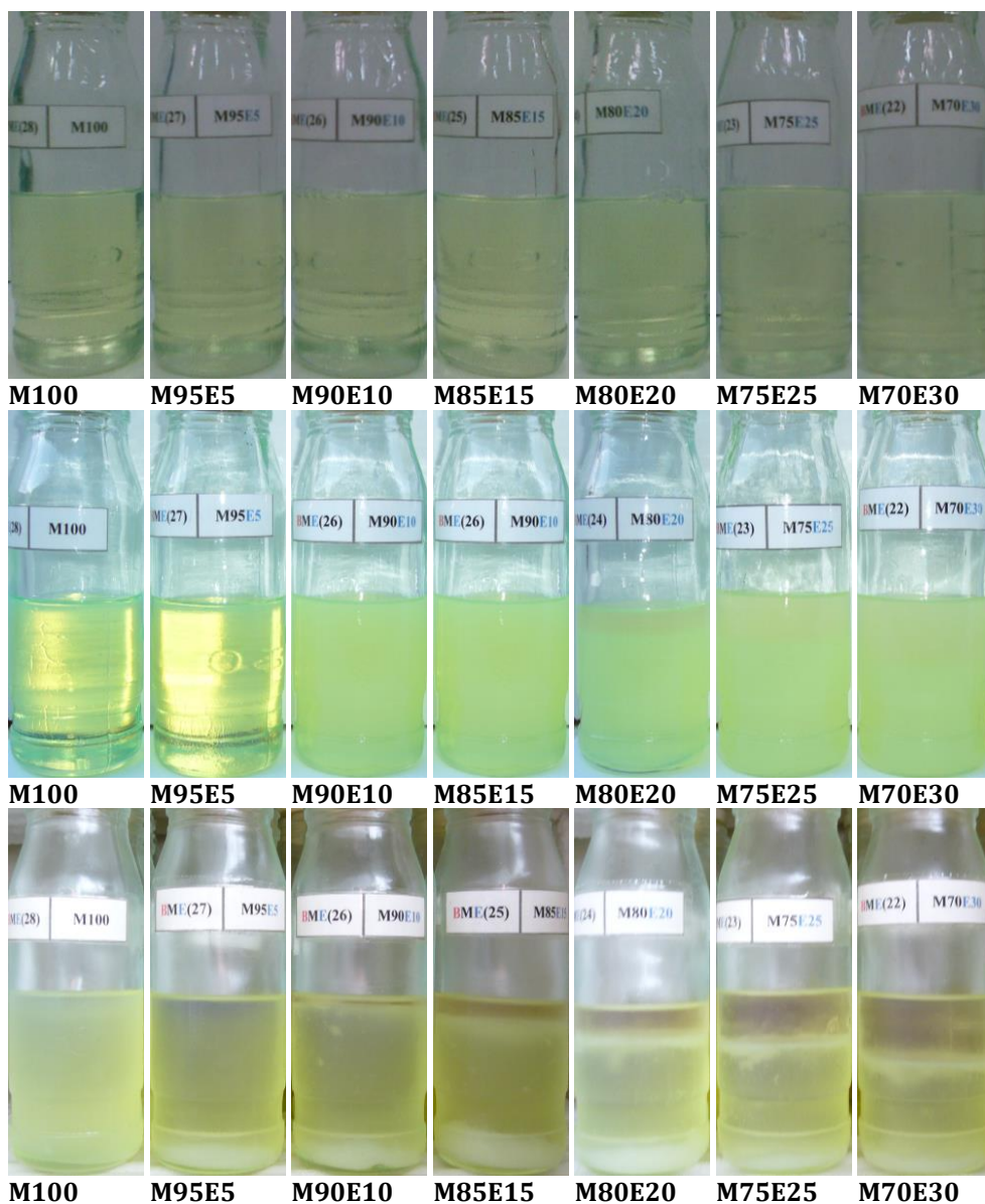
Figura 2.5. Aspectul amestecurilor binare motorină-bioetanol la diferite temperaturi (15 °C sus; 0 °C mijloc; -8 °C jos).
