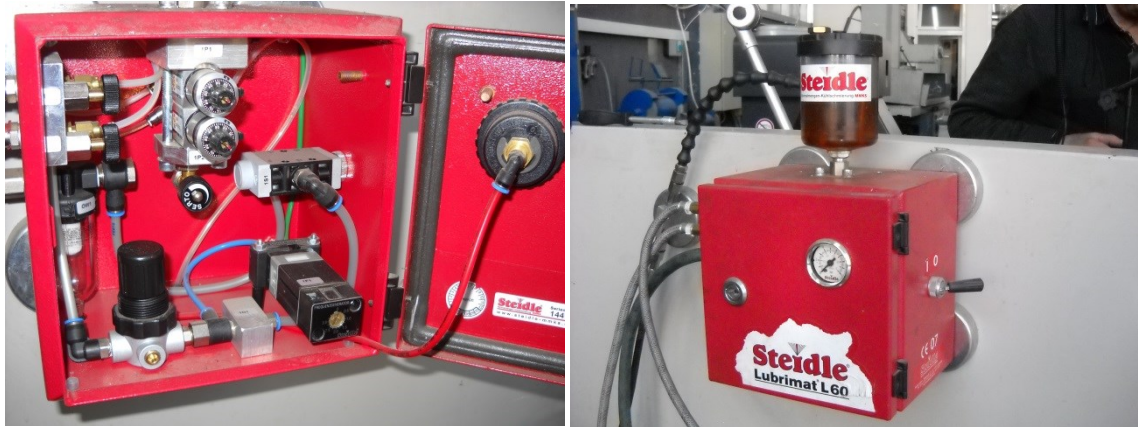
FIGURA 6.3. Echipament LUBRIMAT L60 pentru aşchiere pseudo-uscată.
