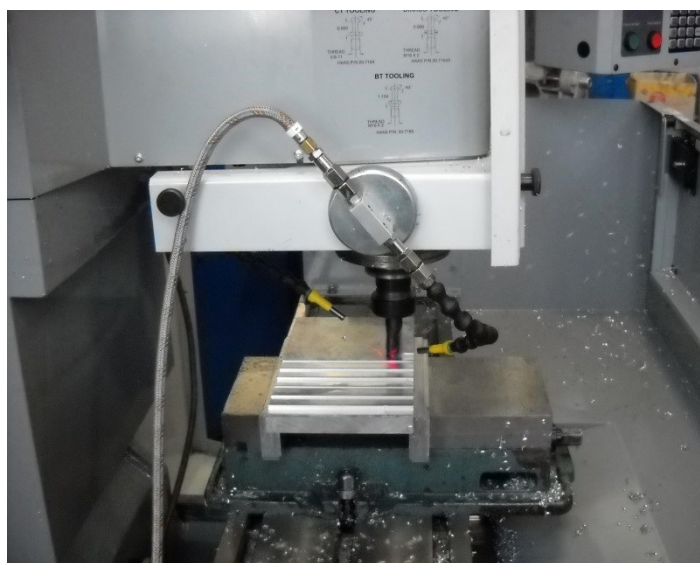
FIGURA 5.5. Frezare plană cu MQL .
