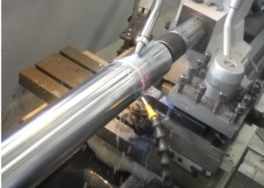
FIGURA 6.1. Strunjirea cu ungere și răcire convențională a AISI 1045 .
