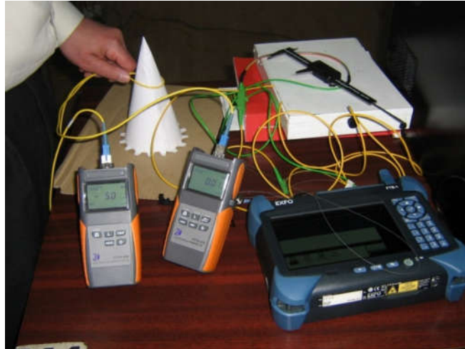
Fig 2.48. Echipamentul de lucru, din ansamblul experimental (analizor de putere și OTDR – optical time domain reflectometer) pentru calibrarea senzorului
