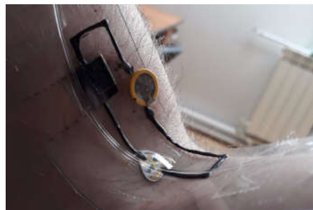
Figura 2.53. Implementare principală a senzorului de îndoire implementat cu fibra optică fluorescentă.
