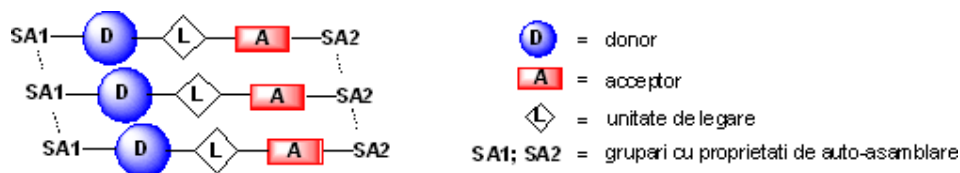
Figura 2.76. Reprezentare generală a conceptului de celule solare organice unicomponente (SMOSC-uri) – sursa proiect ORGLIGHT WEB Page [SMOSCs2017].
