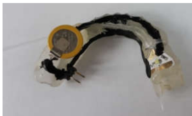
Figura 3.2. Circuitul hibrid cu senzor electronic și fibra optică incorporat în gutiera
