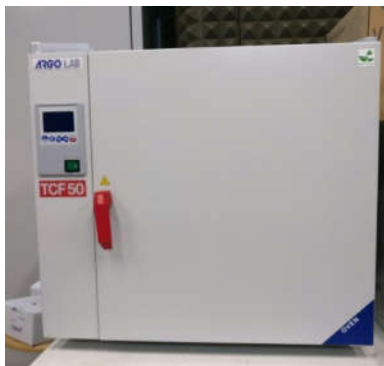
Figura 2.21. Cuptorul folosit pentru depunerea stratului MIP
