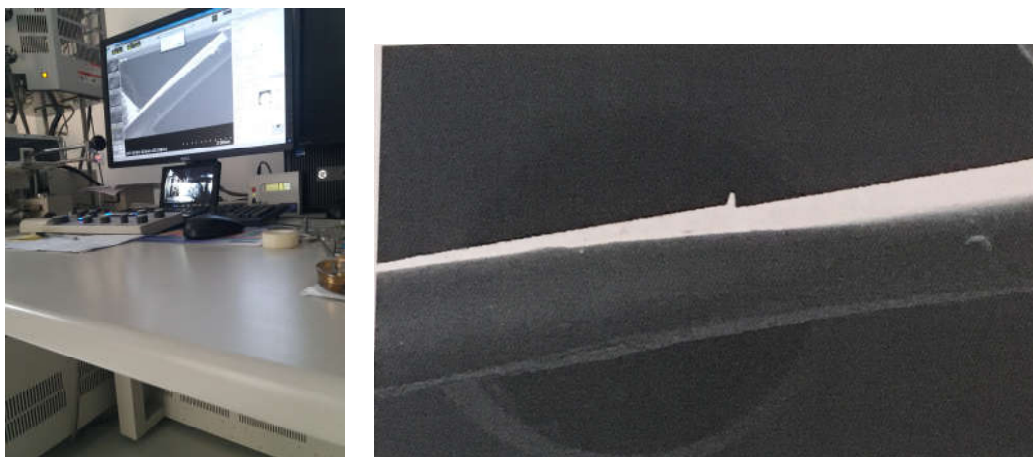
Figura 2.25. Caracterizarea suprafeței fibrei optice cu echipament SEM
