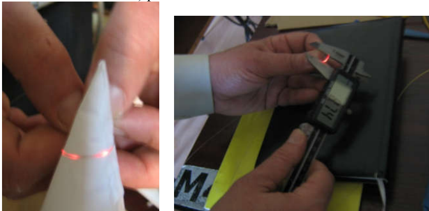
Figura 2.49. Setup masurare – OTDR, PowerMetru, Con de indoire fibra cu raza variabila, fibra de lansare, micrometru digital (pentru raza de indoire)
