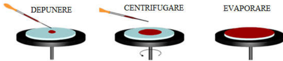
Figura 2.17. Etapele unui spin-coater
