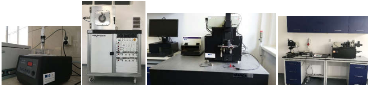
Figura 2.77. Echipamente utilizate în fabricarea și testarea SMOSC-urilor: spin coater, aparat depunere filme subțiri Mantis, profilometru și monocromator, simulator solar ORIEL LCS-100
