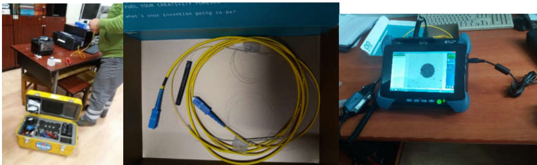
Figura 2.58. Conectorizarea senzorului și monitorizarea gradului de puritate a conectorilor, pentru eliminarea atenuarilor suplimentare
