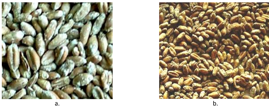
Figura 29. Semințe de grâu; a – distruse de mucegai din speciile Aspergillus , Mucor , Penicillium , Absida , Paecyces etc.; b – tratate în atmosferă bogat ozonată în flux continuu, în spațiu închis, [A2.1.7], [A2.2.2], [A2.2.5], [A2.2.6], [A2.2.12], [A2.2.34], [A2.2.35], [A2.2.36], [A2.2.39], [A2.2.44].
