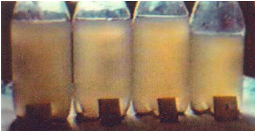
Figura 30. Gradul de limpezire a vinului oțet, la două săptămâni de la tratarea în câmpuri electrice intense de descărcare corona, cu celula în curgere peliculară, [A2.2.7], [A2.2.8], [A2.2.13], [A2.2.29].
