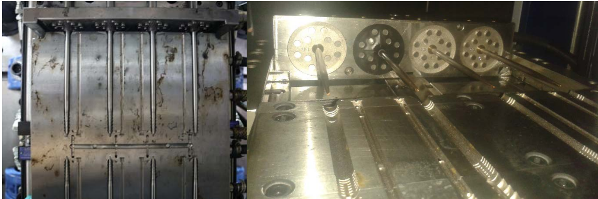
Fig. 175 Matrița montată pe Haitian Mars 2-2500
